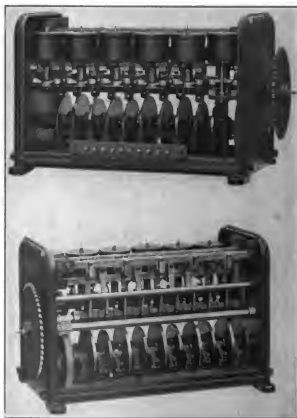
Fig. 193. Steuerapparat (geöffnet) für Druckknopfsteuerungen der A. E.-G.
